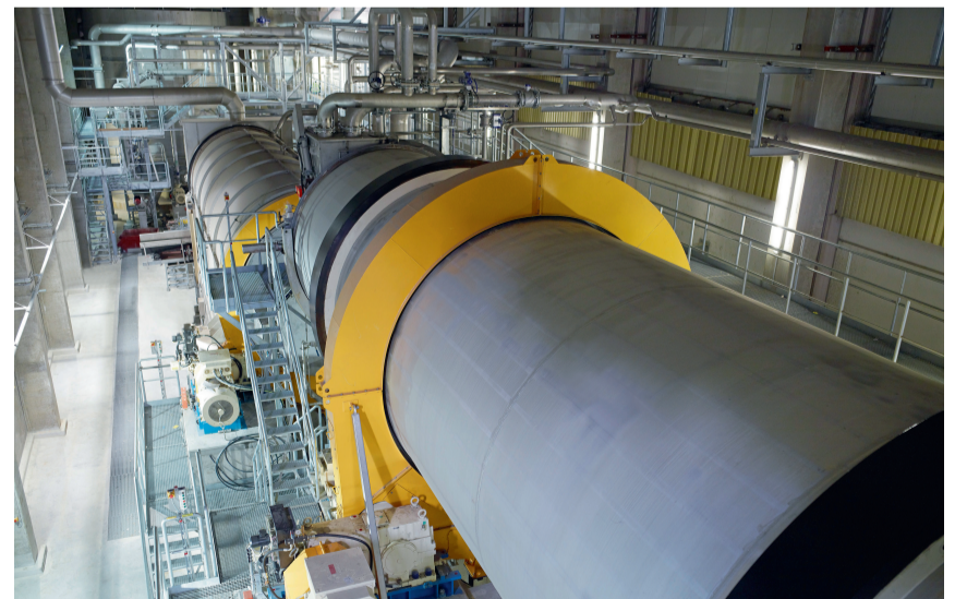
Les cylindres servant à la dissolution du vieux papier et à la fabrication de la pâte à papier.
