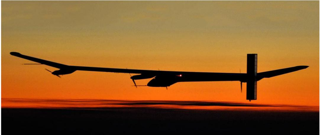
1. Voler la nuit est le plus grand défi qu'un avion solaire doit relever, puisque le soleil ne brille pas. Le pilote doit par conséquent voler en économisant ses réserves, car s'il épuisait l'énergie stockée dans les batteries situées sous les ailes, l'avion s'écraserait. Il est donc heureux de voir le soleil se lever le matin et, ainsi, de pouvoir recharger ses batteries.
